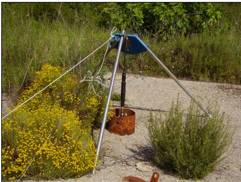
Fotografía 2: Detalle del trípode utilizado al no poder acceder hasta el sondeo. Vista del brocal del sondeo.
