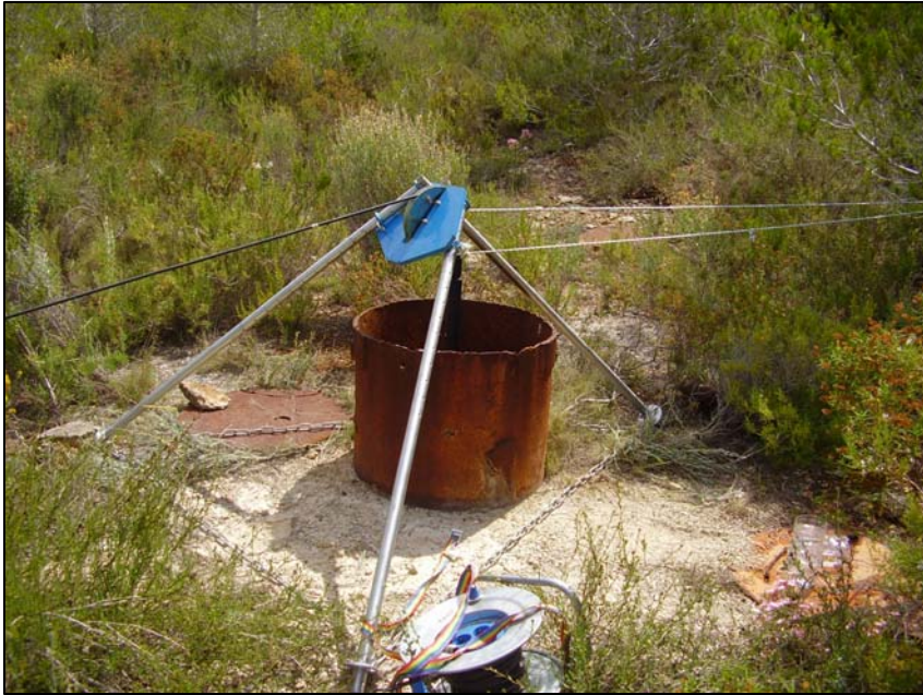
Fotografía N° 1: Brocal del sondeo
